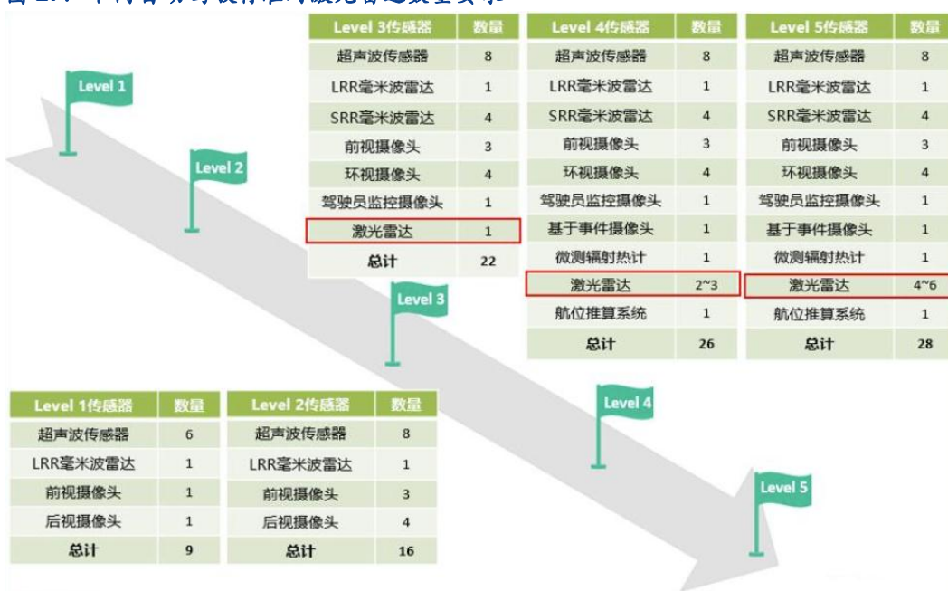
图 27：不同自动驾驶标准对激光雷达数量要求
